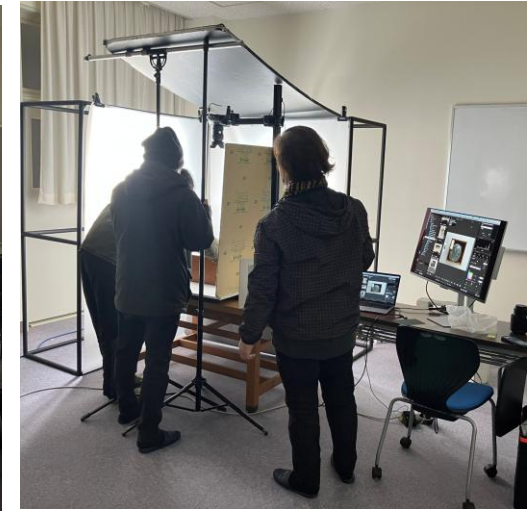
▲丹後震災にて被災した時計：ガラス面の映り込みを防ぐライティング (P.24も参照)
