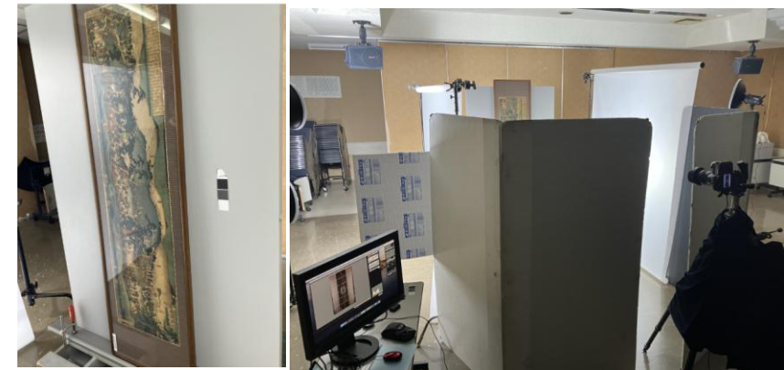
▲額装された大型の山崎大合戦之図を撮影 (反射を抑制するセット組み)
