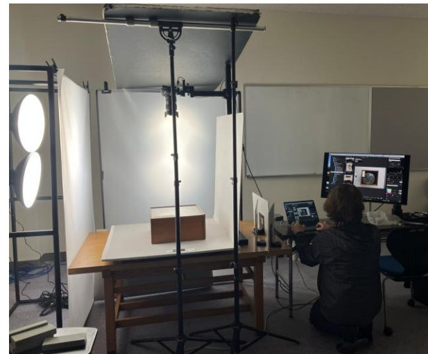
▲丹後震災にて被災した時計：ガラス面の映り込みを防ぐライティング (P.24も参照)
